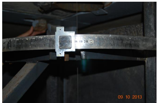
Péndulo en la elevación 8,00
