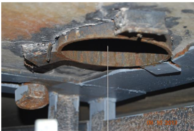
Péndulo en la elevación 8,00
