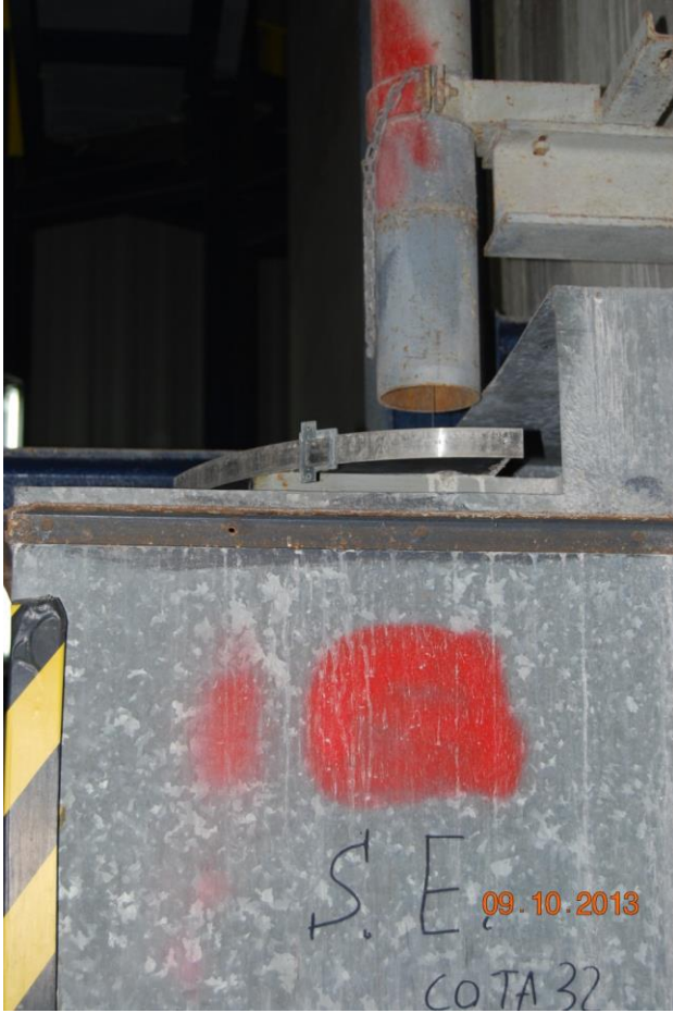
Péndulo en la elevación 32,50
