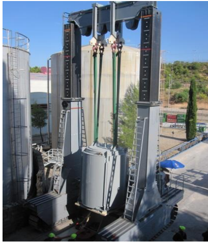
Fig. 9: TRASLADO CON EL CRAWLER DEL HI-TRAC, AL FOSO DE TRANSFERENCIA DEL ATI
