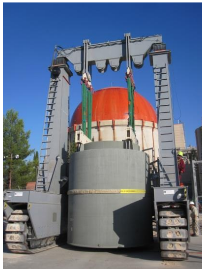
Fig. 13: TRASLADO DEL HI-SAFE, DESDE EL FOSO DE TRANSFERENCIA AL ATI.
