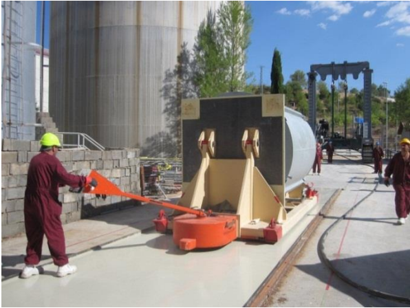
Fig.7: RETIRADA DEL HI TRAC POR EL CRAWLER
