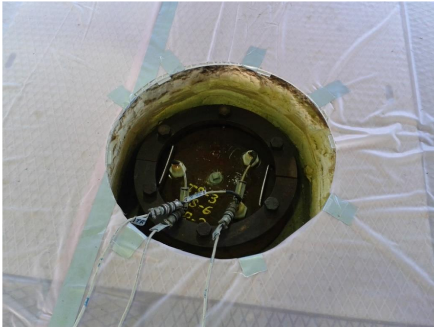
Foto 9. Penetración de instrumentación de temperatura F13M11.
