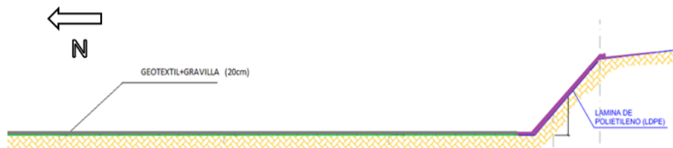
Fig. 5-3 . Colocación de lámina de LDPE (Cambiar imagen)
