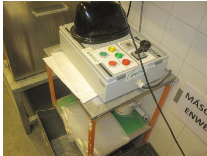
Figura 16.- Conjunto equipo de medición de estanqueidad de máscaras y mesa
