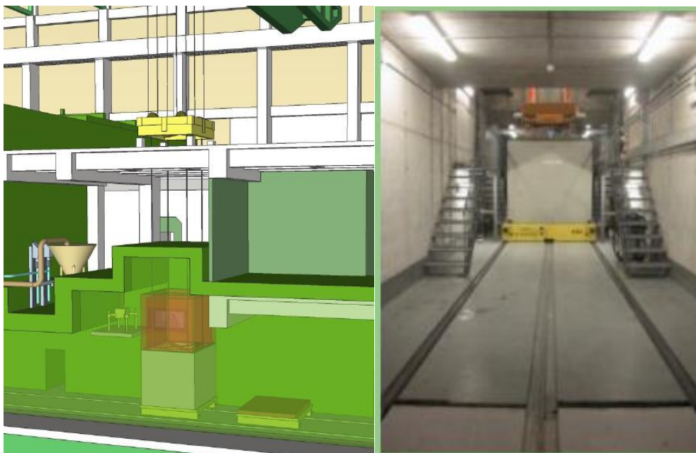
Figura 6. Túnel de transferencia EAD y escaleras/plataformas de trabajo.
