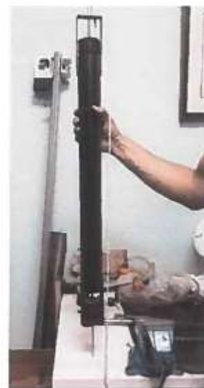
Útil toma de muestra agua superficial a 50 cm de profundidad, con aprox. 1,2 litros de capacidad mediante un sistema de doble émbolo
