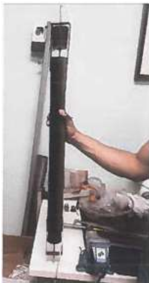
Útil toma de muestra agua superficial a 50 cm de profundidad, con aprox. 1,2 litros de capacidad mediante un sistema de doble émbolo
