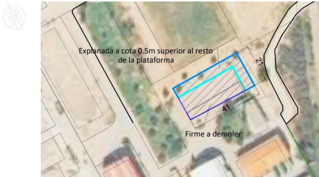
Figura 8. Desnivel a acondicionar en la plataforma de ubicación de la losa
