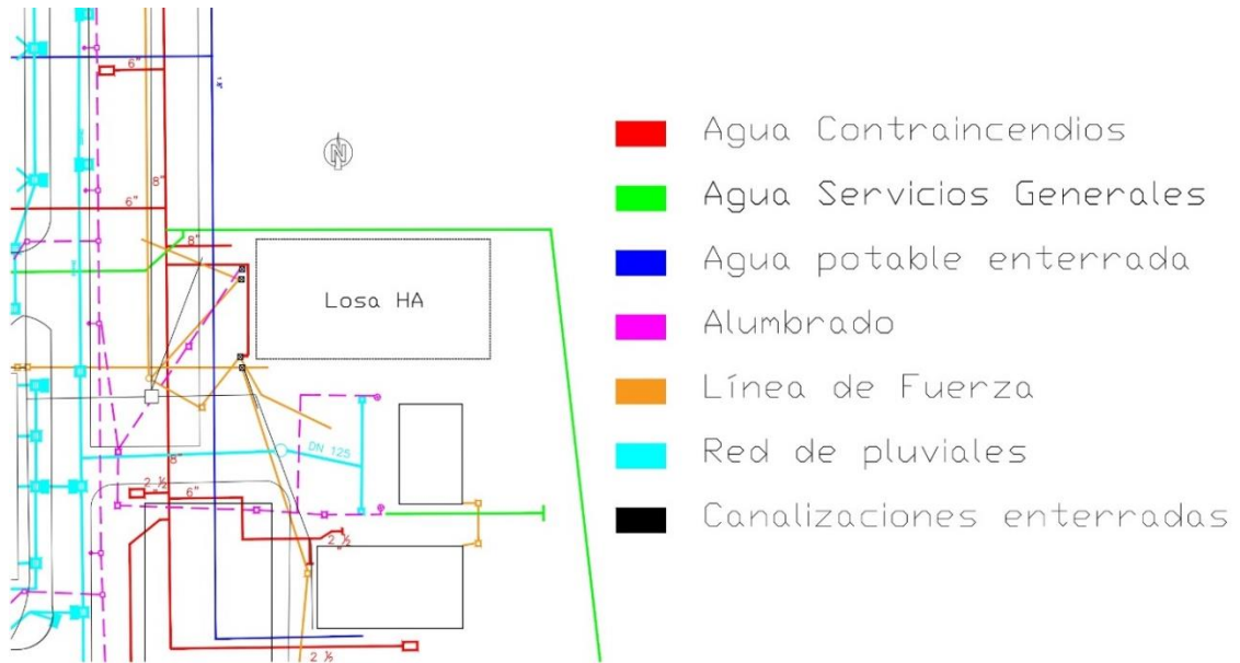
Figura 6. Canalizaciones en las inmediaciones de la losa de HA
