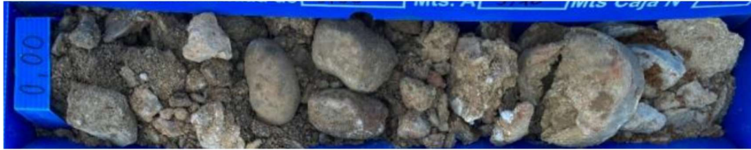
Figura 11. Detalle de los niveles de relleno antrópicos en el sondeo nº3 de 0,0 a 0,6 m de profundidad.
