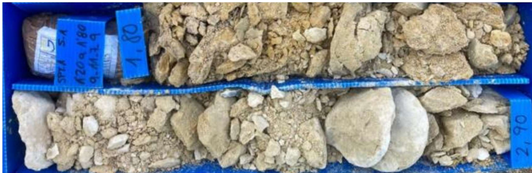
Figura 12. Detalle de los niveles de relleno antrópicos en el sondeo nº1 de 1,8 a 2,9 m de profundidad.
