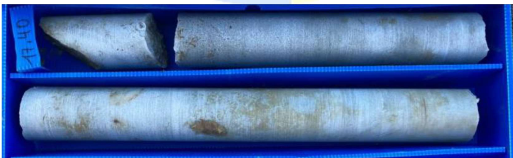
Figura 32. Detalle de los niveles de calizas en muestra del sondeo S-1 de 17,40 a 18640 m de profundidad.
