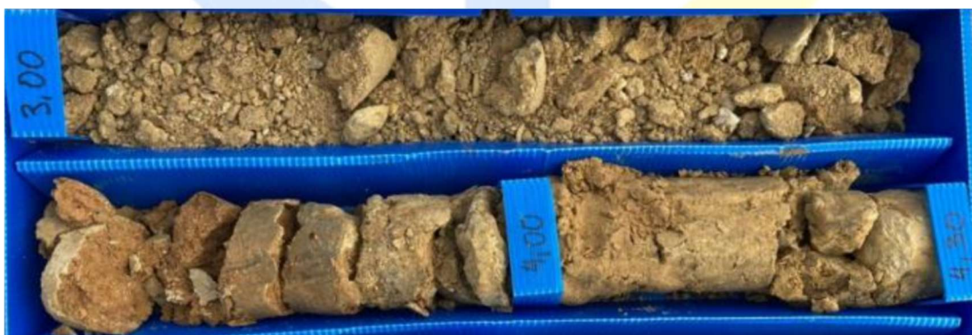
Figura 22. Detalle de los niveles de arenas de color naranja-ocre con gravas redondeadas cuarcíticas, en muestra del sondeo nº1 de 3,0 a 4,3 m de profundidad.
