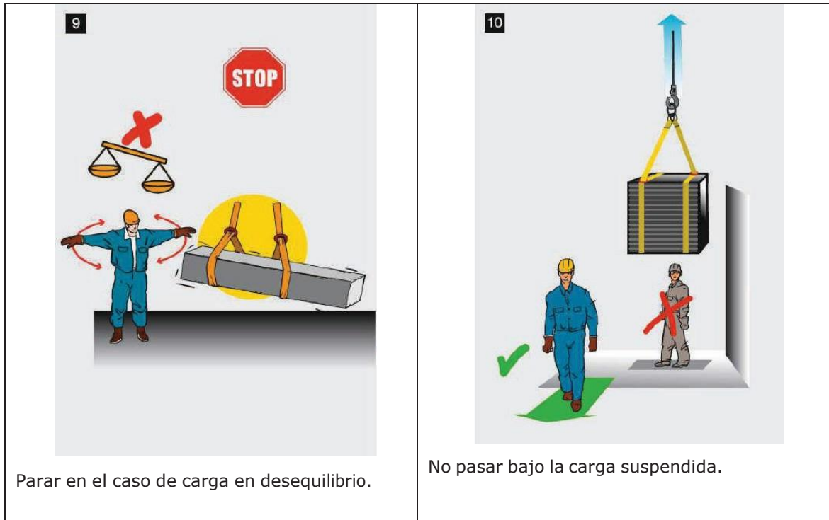
Figura 35. Izado de Cargas 3.
