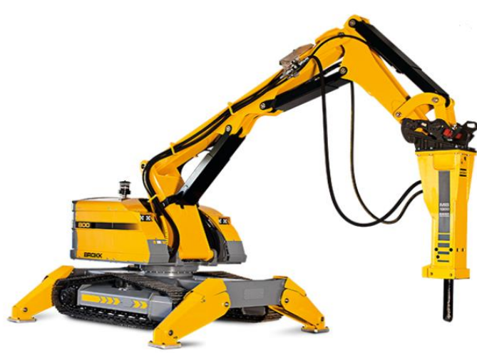
Figura 41. Ficha técnica Robot tipo Brokk 800.
