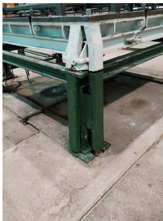
Ilustración 6. Patas bancadas de encofrados de tapas.
