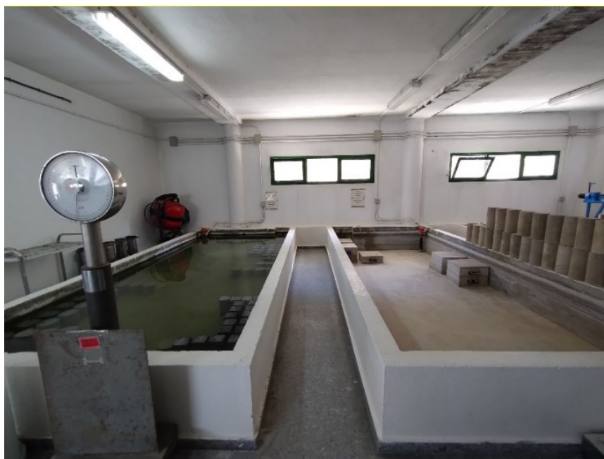
Ilustración 12. Balsas de curado.
