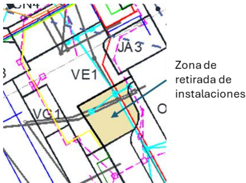
Figura 9.- Instalaciones a retirar en VE1
