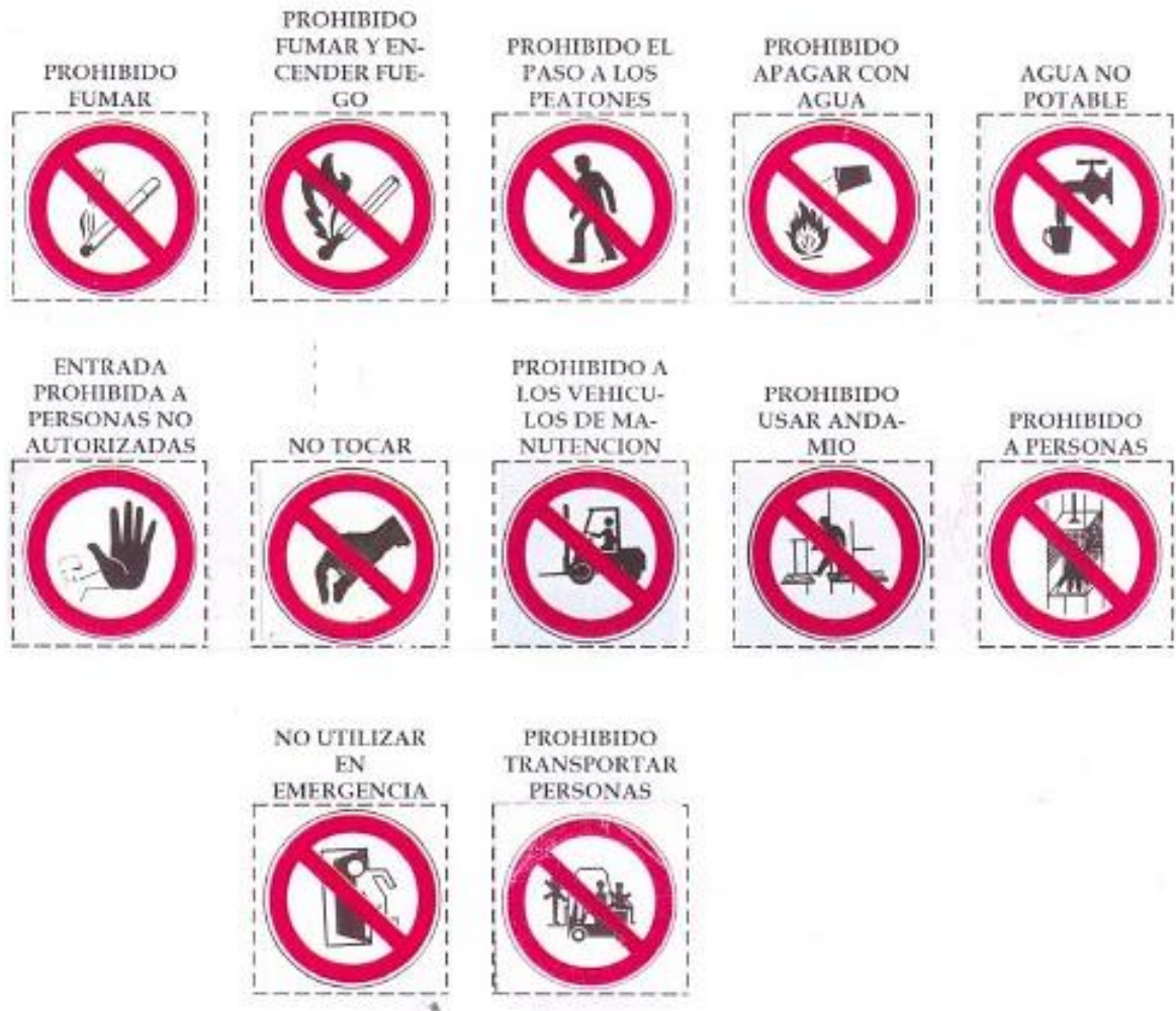
Figura G.11 – Señales de prohibición
