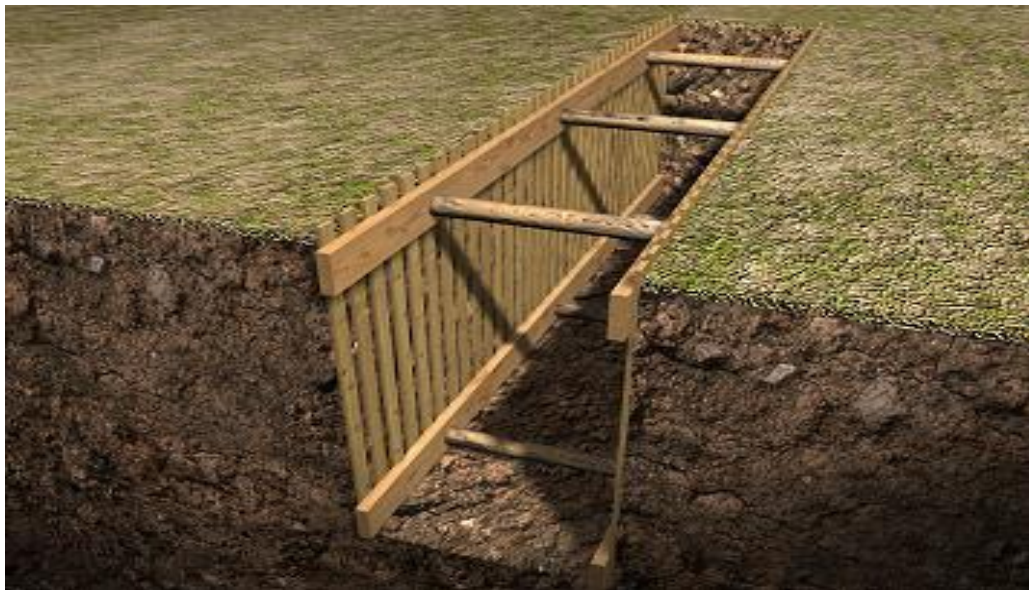
Figura 7.- Ejemplo de entibación semicuajada con tablas verticales
