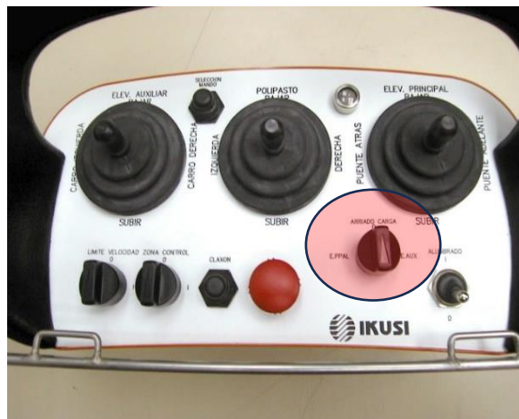
Fotografía 16: Detalle del control de izado de cargas en mando
