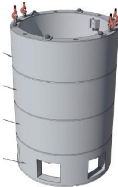
Figura 8. Croquis de los módulos auxiliares de blindaje, sin su tapa.
