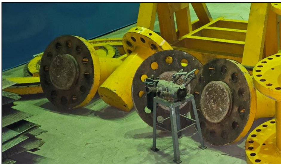
Figura 29: Bulones de izado del estátor
