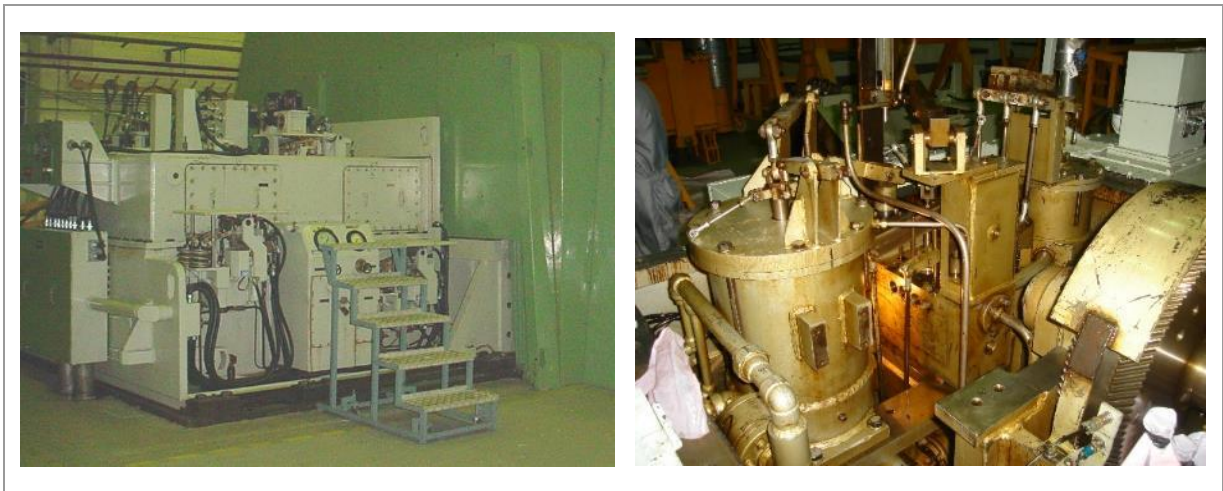
Figura 21: Componentes del cabezal de control de turbina
