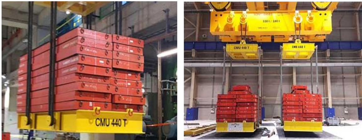
Figura 27: Ejemplo prueba de carga con lastres metálicos
