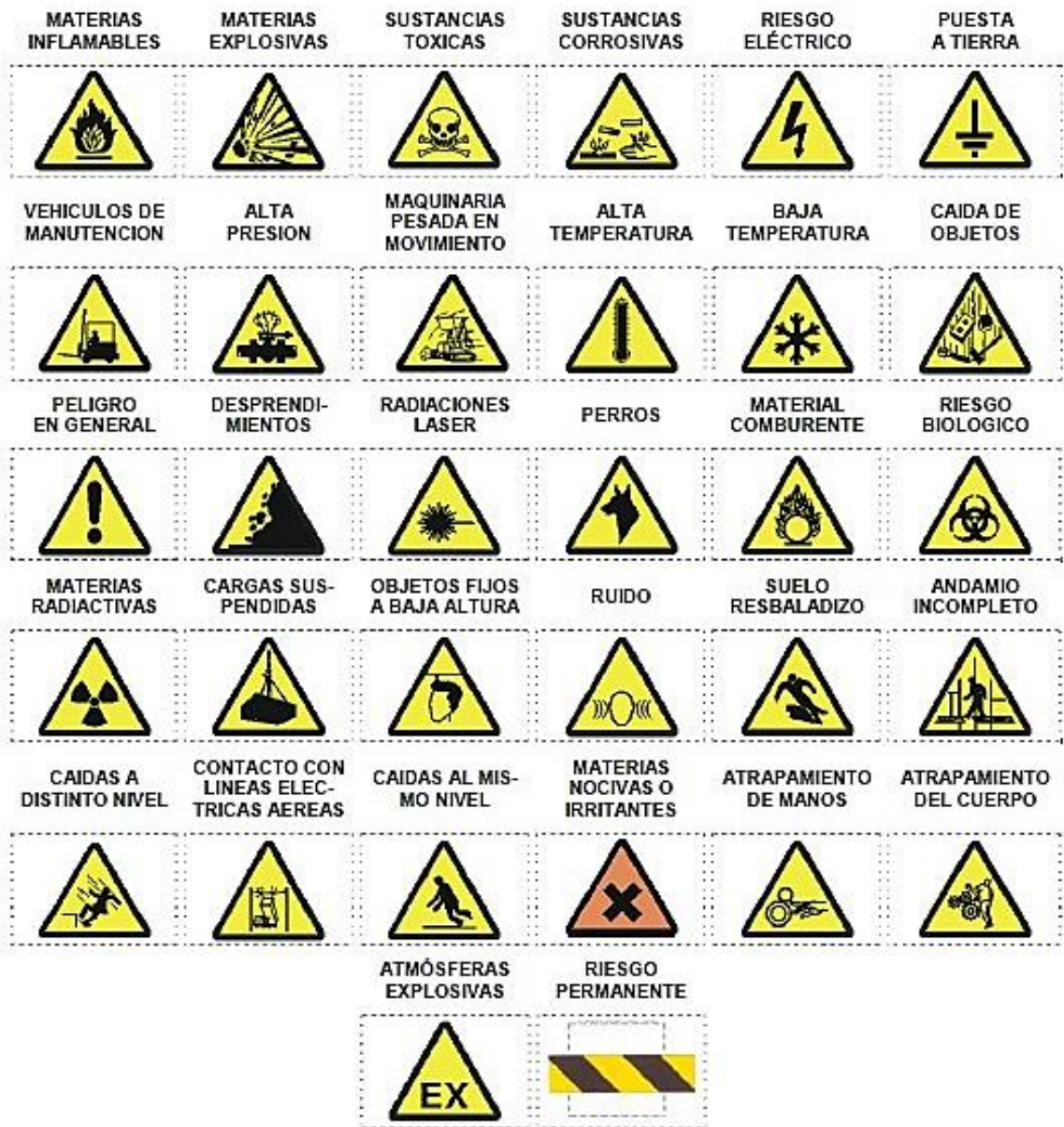
Figura 6: Señales de advertencia
