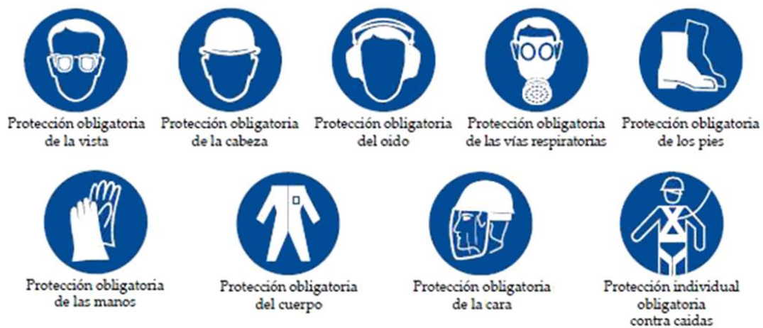
Figura 4-2: Equipos de Protección Individual general
