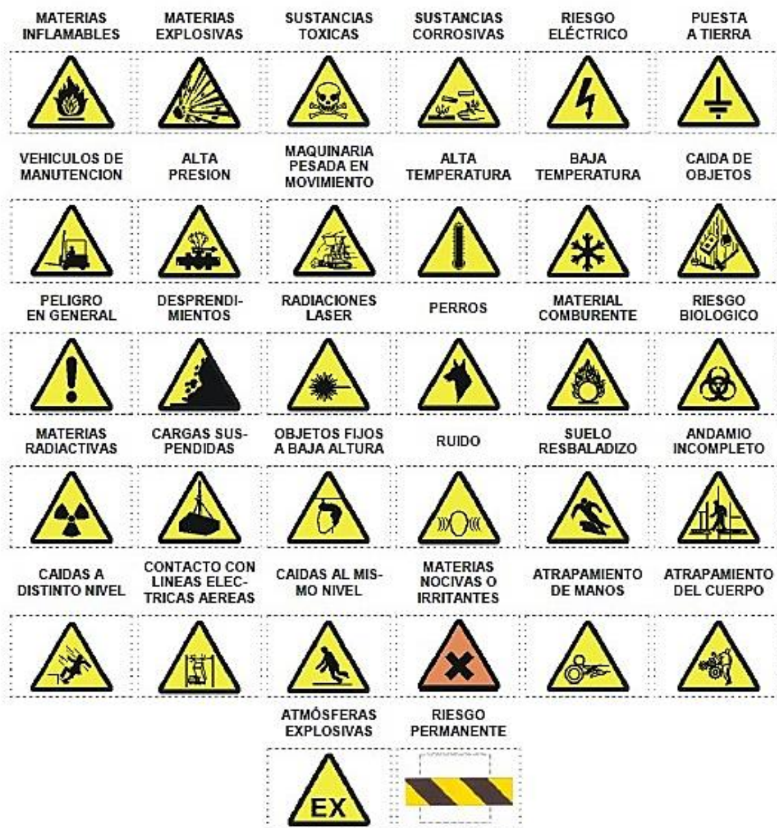
Figura 4-6: Señales de advertencia
