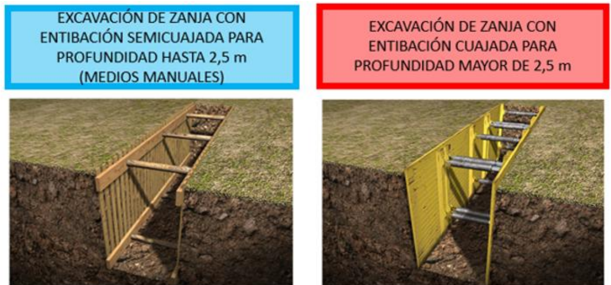
Ilustración 12 Ejemplo de Entibación Semicuajada y Cuajada
