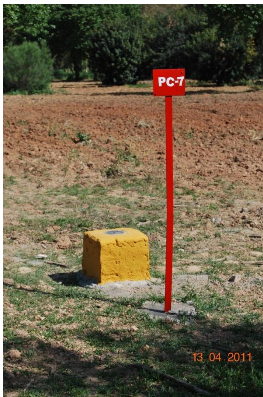
Fotografía 2: Señalización de elementos de vigilancia y control (interior).
